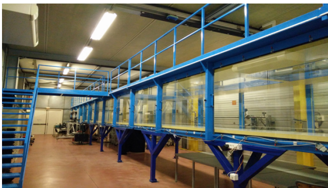
FIG. 10. Photo of the boundary layer wind tunnel at Laboratoire de Mécanique de Lille (LML).
