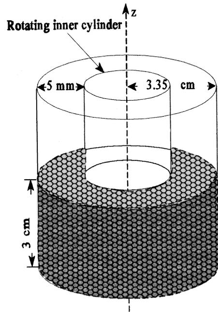
FIG. 1. The Couette apparatus.
