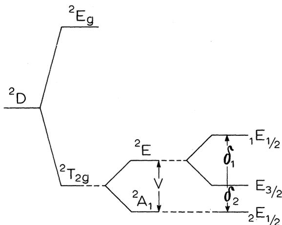
FREE ION + CUBIC FIELD + TRIGONAL + SPIN ORBIT
