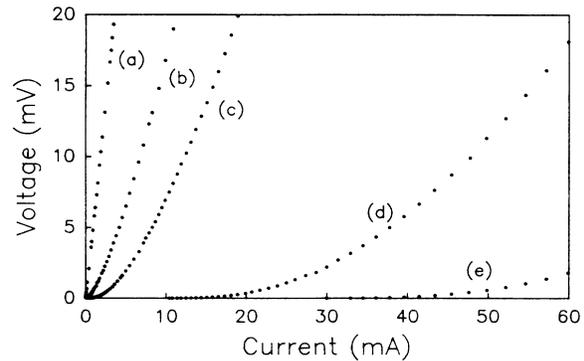
FIG. 2.  $I$ - $V$  curves at (a) 89 K, (b) 79.5 K, (c) 76 K, (d) 51 K, and (e) 10 K.
